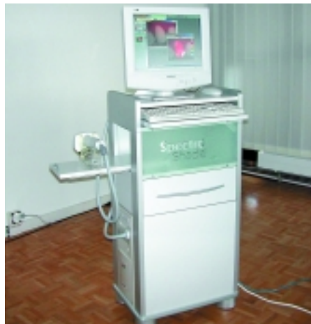
Abb. 4: Das Spektralphotometer (Typ MHT SpectroShade) analysiert die Helligkeitswerte, Intensitäts- und Farbwerte des Zahns mit exakten Angaben ganzheitlich und regional. Das Ergebnis wird dem Muster des industriellen Farbschlüssels gegenübergestellt und Abweichungen angegeben. Die Übereinstimmung bei Wiederholungsmessungen zeigt eine hohe Verlässlichkeit des Systems. Foto: AG Keramik/MHT
