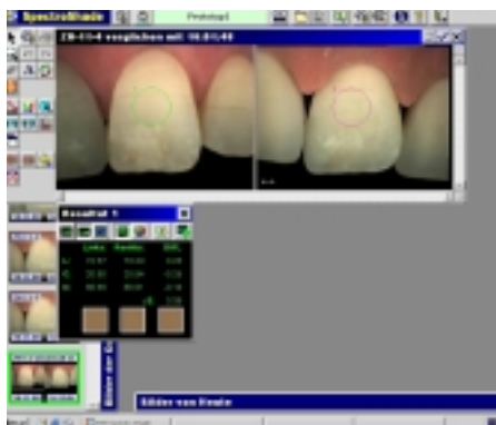
Abb. 2: Der Mundsimulator vergleicht die Farben der im Labor hergestellten Keramikrestauration mit dem natürlichen Zahn. Links die natürliche Zahnfarbe (grüner Ring), rechts die vom SpectraShade definierte Zahnfarbe (roter Ring). Mit der Spotmessung lassen sich alle Zahnflächen auf Farbidentität mit dem Naturzahn überprüfen.
