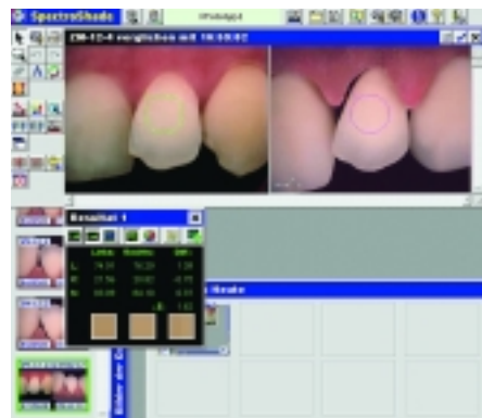
Abb. 9: Rechts die Keramikkrone in der Gingivamaske des Mundsimulators bei der Vergleichsmessung gegen den Naturzahn (links). Der Zahntechniker hatte den Patienten nicht gesehen; die Farbmessung am Behandlungsstuhl und die Kontrollmessung an der Krone im Labor ergaben identische Farbwerte. Foto: Dr. Paul/ZTM Pietrobon/AG Keramik
